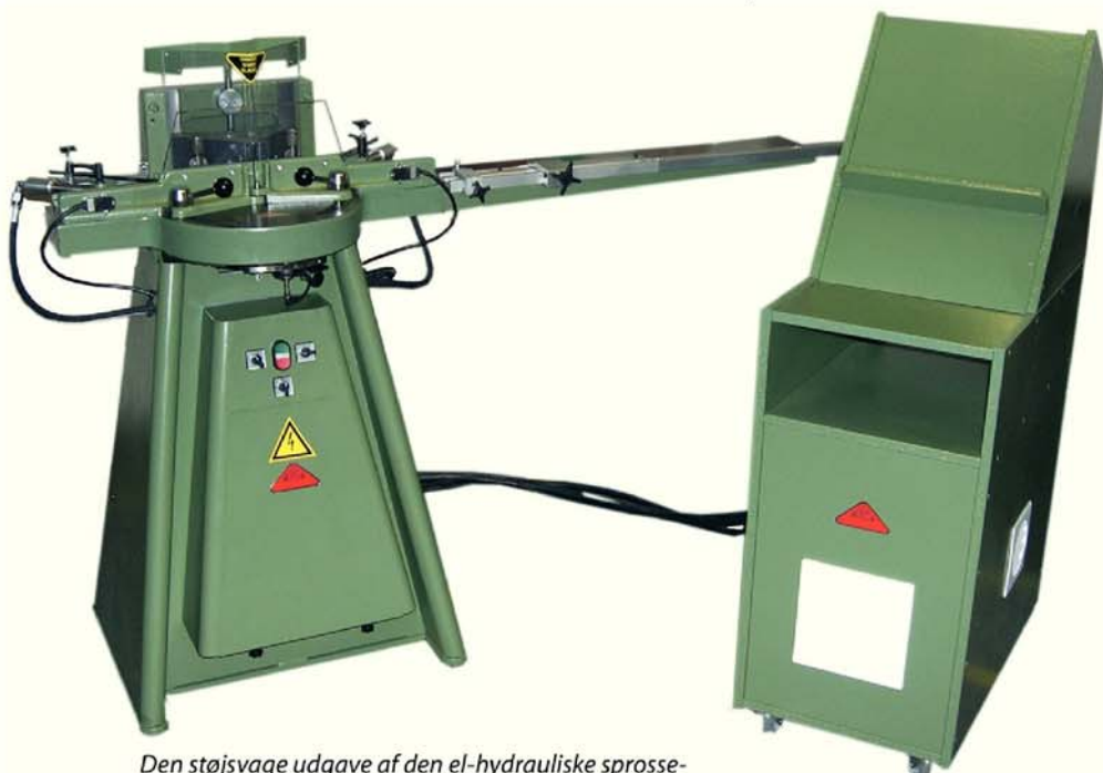
Den støjsvage udgave af den el-hydrauliske sprosse- og gehringsklipper arbejder i princippet efter samme retningslinjer som den første model fra 1911.
